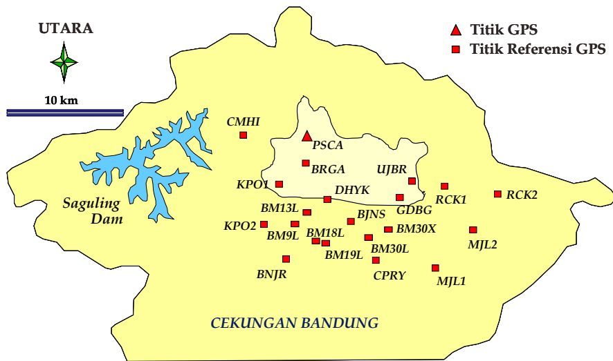
Gambar 21. Jaring GPS untuk studi penurunan tanah di Bandung.
