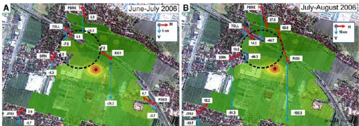
Gambar. 6 Survei pertama pengukuran jangka panjang antara Juli dan Agustus 2006. Kotak putih adalah pergerakan dalam sentimeter, setelah awal dari semburan. Daerah ditutupi dari survei ini = besarnya subsidence. The area covered by these campaigns -= subsidence. V pergerakan vertikal, H pergerakan horizontal sekitar pusat semburan (orange bulls eye). a, b Panjang dari panah pada setiap kasus merupakan proporsi dari displacement horizontal dan vertical antara Juni dan Juli 2006.
