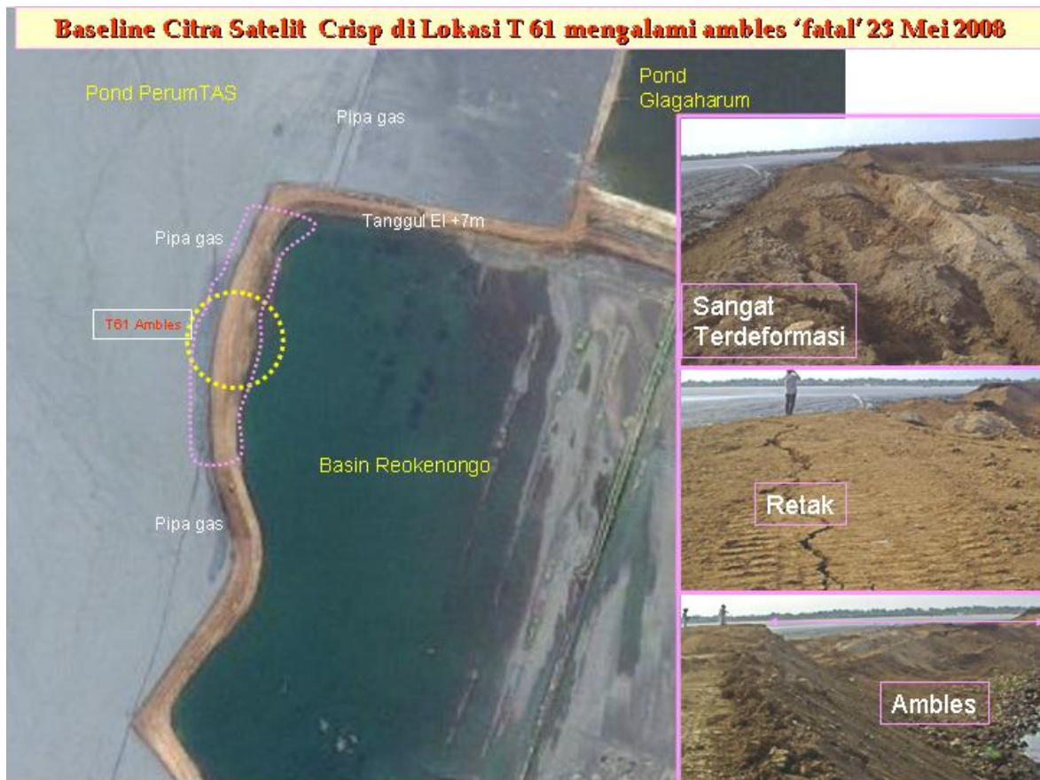
Gambar 53. Foto-foto memperlihatkan bagaimana dahsyatnya akibat runtuhnya Tanggul Reno yang terjadi hanya dalam satu malam, sepanjang 250 meter dengan ketinggian runtuhannya sekitar 2m, hal ini bisa dibandingkan dengan runtuh sekitar pusat semburan terjadi 2 Juni 2008.
