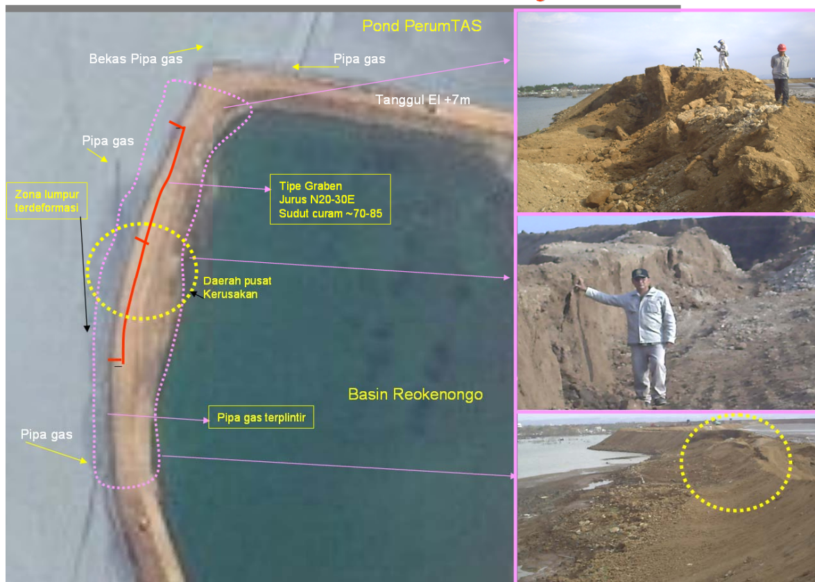
Gambar 25. Runtuhnya seketika (sudden collapse) Tanggul 6.1 dengan pola terban (graben), sepanjang 200m, dalam >2m terjadi dalam satu malam saja.
